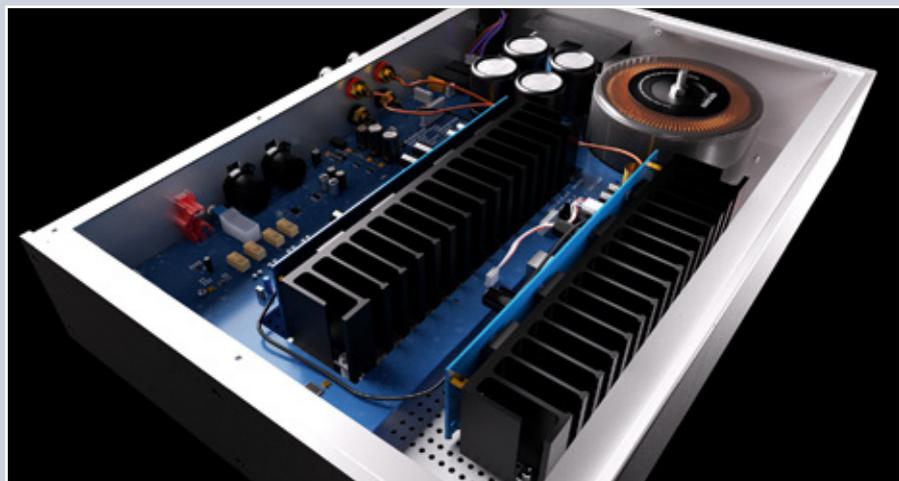
Im Inneren der 9000P kommt die Current-Feedback-Technologie (CFB) zum Tragen, die maßgeblich für die schnelle und präzise Signalverarbeitung der Endstufe verantwortlich ist
