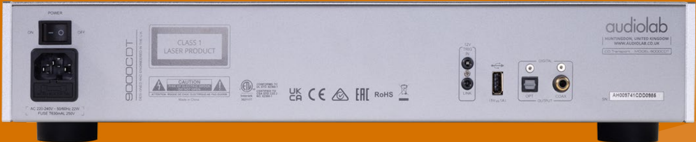
Als reiner Transporter verzichtet der 9000CDT auf einen DAC (Digital Analog Converter). Dementsprechend verfügt der 9000CDT rückseitig einzig über digitale Schnittstellen
