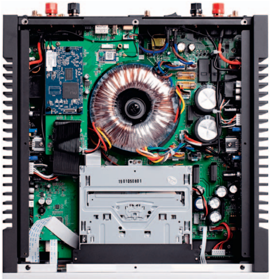
BILDSCHÖN: In der absoluten Mitte liegt ein massiver Ringkern-Transformator. Davor an der Front: ein Slot-in-Laufwerk von Panasonic. Die Wärme geht an die seitlichen Kühlrippen.
