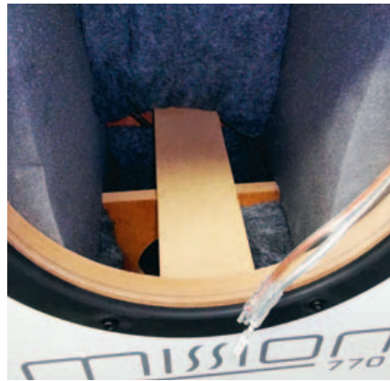
Der Aufwand beim Gehäuse, zahlreiche Verstrebungen plus CLD, gehen weit über das in der Preisklasse Übliche hinaus.
