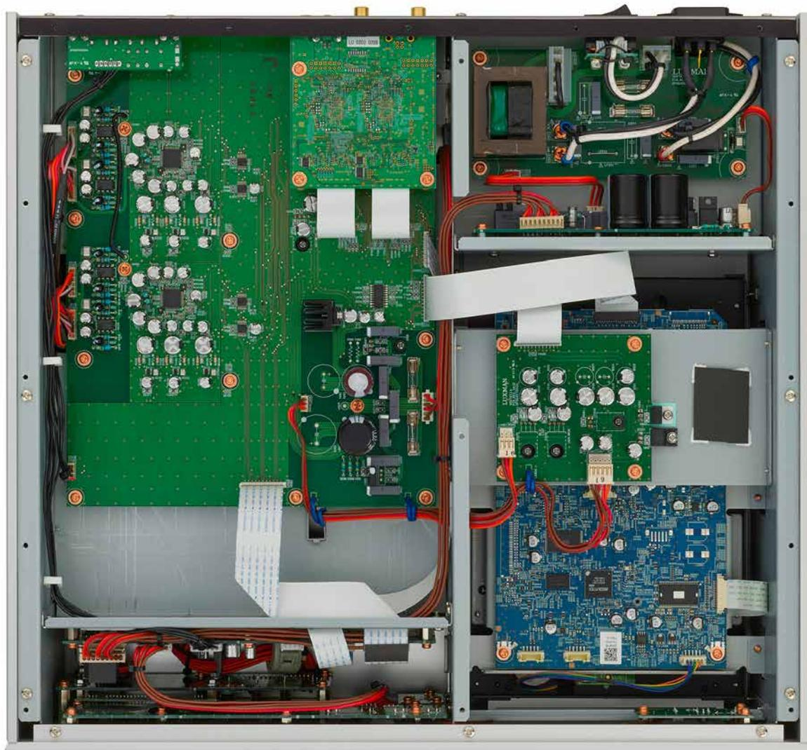
... hätten Sie's bemerkt?: Die digitale Abteilung ist, durch eine Trennwand isoliert, an der Unterseite des Players montiert. Maximale Diskretion bei kürzesten Signalwegen. Rechts oben sehen Sie den Stromeingang nebst Standby-Trafo, darunter erkennt man die Stromversorgung (grün) und Steuerung (blau) des CD/SACD-Laufwerks.
