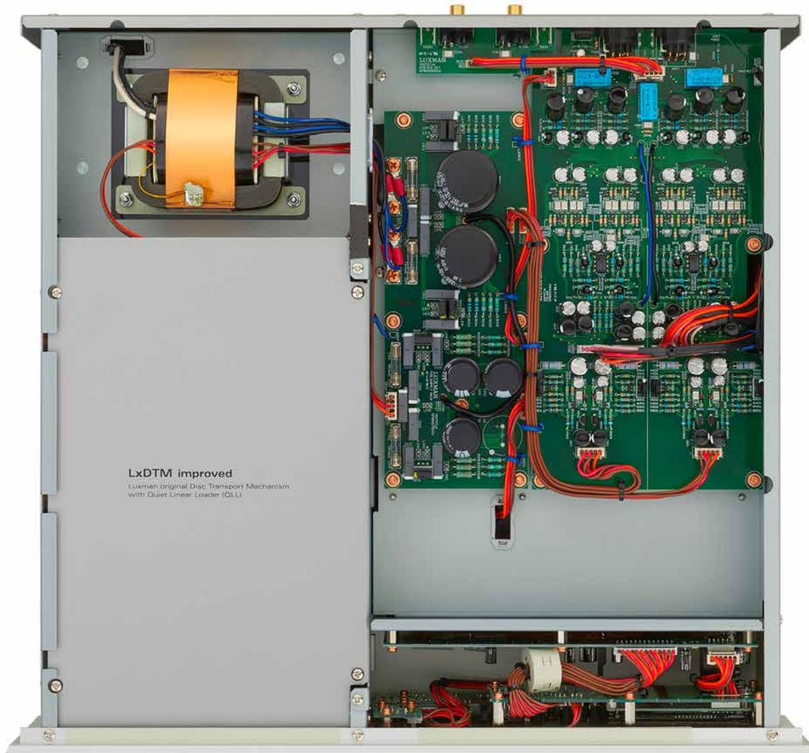
Und hier noch eine Demonstration in „exzellentem Gerätedesign“: Das Laufwerk ist gekapselt, was nicht nur die Lebensdauer steigert, sondern auch die Wirkung von Streulicht unterbindet. Der Trafo liegt einsam und isoliert in einer eigenen Gehäusekammer. Die analogen Ausgangsstufen (rechts) liegen mit ihrer Netzaufbereitung auf einer eigenen Platine und ...
