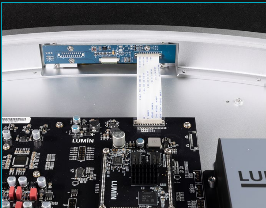
Die leistungsfähige Streaming-Einheit des T3 ist mit einem smarten, Linux basierenden Prozessor aufgebaut. Von dort wird das Signal an den FPGA-Chip weitergeleitet
