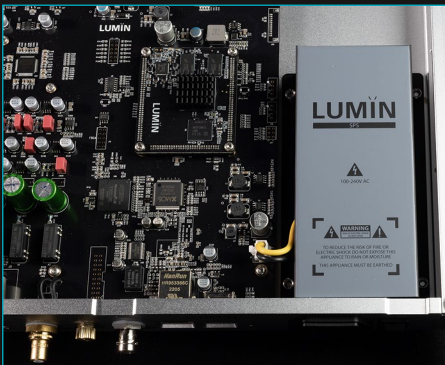
Die digitale Wandlung wird mit zwei ESS ES9028PRO Sabre DACs in Dual-Mono-Konfiguration besorgt. An diese Sektion schließt eine rein symmetrische Analogstufe an
