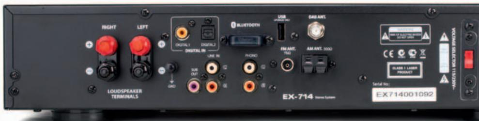
Die Ausstattung ist üppig: zwei Digitaleingänge plus USB-B, 1 x Phono MM, 1 x analog, Subwoofer-Out, Bluetooth und diverse Antennenanschlüsse. Das langt.
