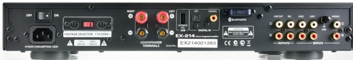
**ANSCHLUSSFREUDIG:** Auf der Rückseite des EX-214 finden sich nicht nur Anschlüsse für Line und Phono, sondern auch zwei Digitaleingänge (optisch und koaxial). Der integrierte DAC PCM1606 von Texas Instruments verarbeitet HiRes-Signale in einer Auflösung von bis zu 24 Bit und 96 Kiloherz.
