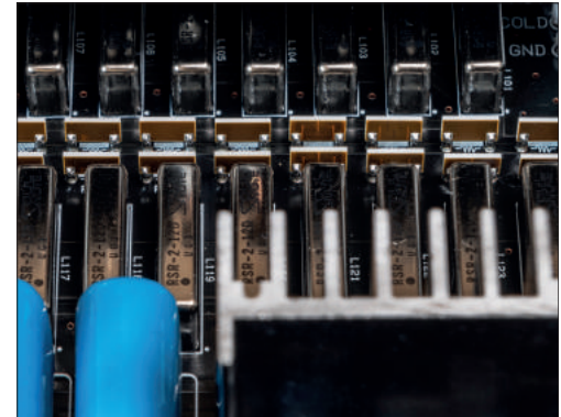
Sündhaft teure Folienwiderstände bilden das Herz des extrem aufwändigen Pegelstellers
