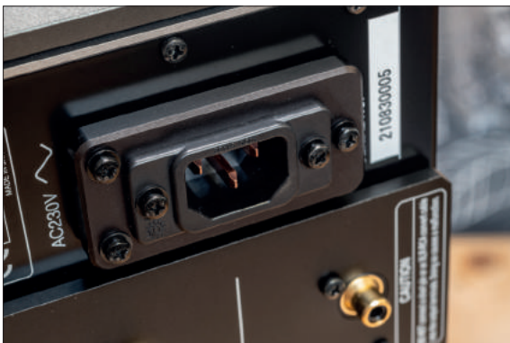
Sogar die Netzeingangsbuchse ist mechanisch entkoppelt montiert
