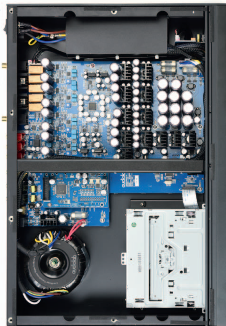
Das Slot-loading-Laufwerk (rechts unten) ist schnell und leise. Zentrale Bereiche des Players werden von einer Stromversorgung aus Ringkerntrafo, Siebkondensatoren und elektronischen Spannungsregelungen versorgt. Die Treiber am Ausgang weisen schon ehrfurchtgebietend geringen Ausgangswiderstand auf.
