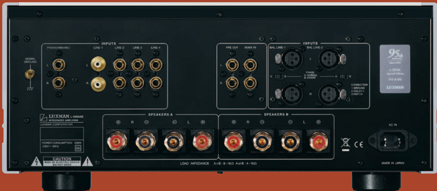
Schaltbare absolute Phase an den symmetrischen Eingängen ist ein selten anzutreffendes Feature. Die Line-1-Buchsen sind besonders hochwertig ausgeführt, der danebenliegende Phonoeingang akzeptiert MM- und MC-Tonabnehmer, wobei die 100-Ohm-Impedanz für MC fix ist.
