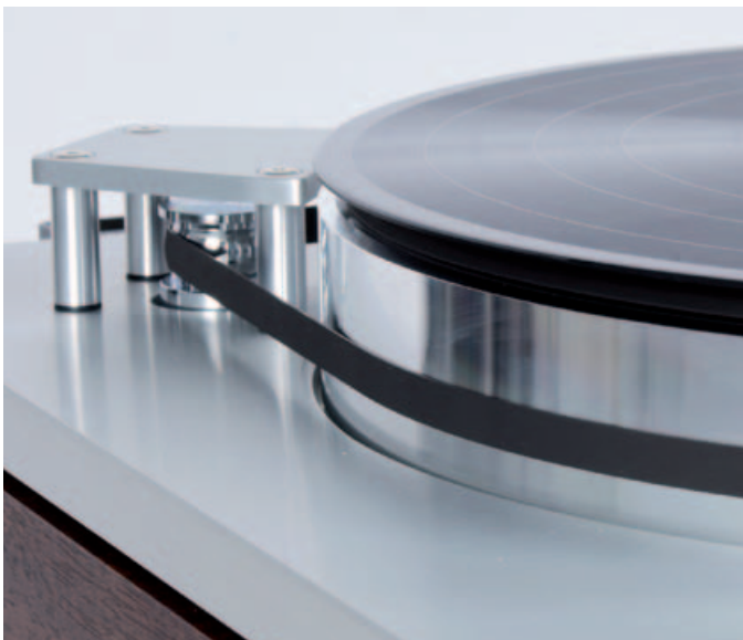
DREH- UND ANGELPUNKT: Der Motorpulley des Luxman PD 171A dreht sich nahe beim Teller unter einem schützenden Aluminiumdach. Er treibt den 5 Kilogramm schweren Aluminium-Gussteller mit einem etwa 7 mm breiten Riemen an, der außen herum anliegt.
