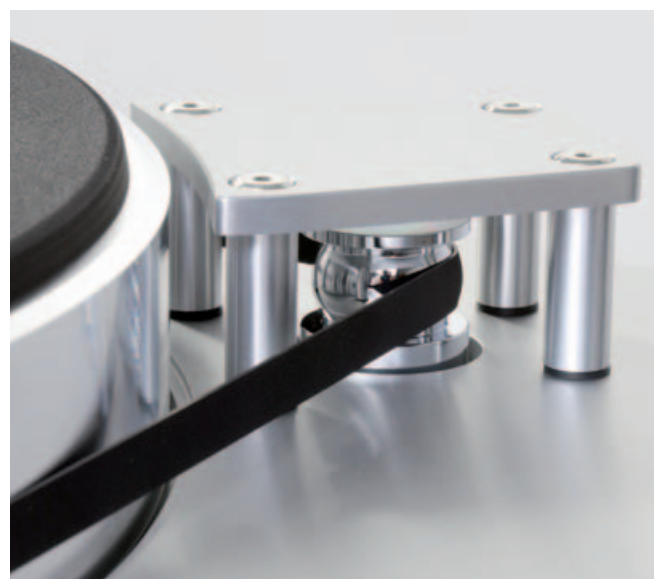
DREH- UND ANGELPUNKT: Der Motorpulley des Luxman PD 171A dreht sich nahe beim Teller unter einem schützenden Aluminiumdach. Er treibt den 5 Kilogramm schweren Aluminium-Gussteller mit einem etwa 7 mm breiten Riemen an, der außen herum anliegt.
